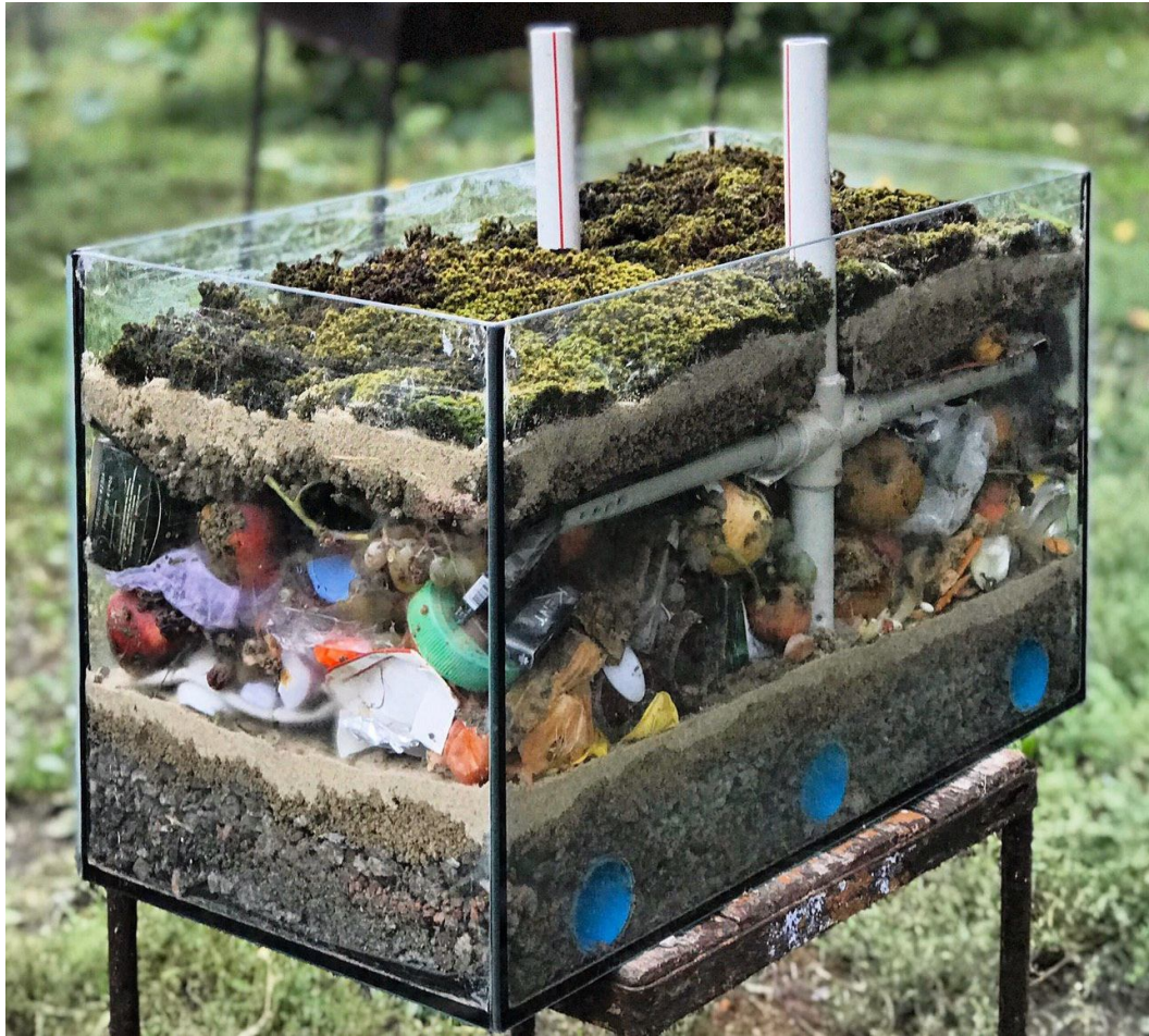
Рис. Макет полігону твердих відходів зі скважинами для вилучення біогазу
